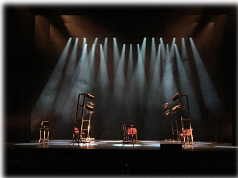
Figura 40 - Foto dos grupos 15,16,18,19,20. Com filtro \frac{1}{2} CTB transformando 3200 Kelvin em 4100 Kelvin. Luz mais fria.
